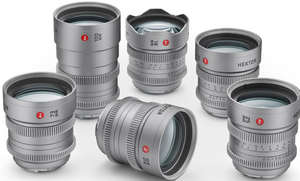
徠茲HEKTOR鏡頭系列包含6顆全片幅定焦鏡頭，透過可互換的無反鏡相機卡口（E、L、RF、Z）支援不同片幅拍攝。焦距涵蓋18mm、25mm、35mm、50mm、73mm和100mm，統一T2.1光圈。所有鏡頭均為全手動設計，位置一致的對焦環與光圈環間距方便快速更換鏡頭。120°對焦旋轉角度讓手動操作更為便利。鏡頭組小巧輕量化，統一採用80mm前口直徑配77mm螺紋濾鏡接口（18mm除外）。
